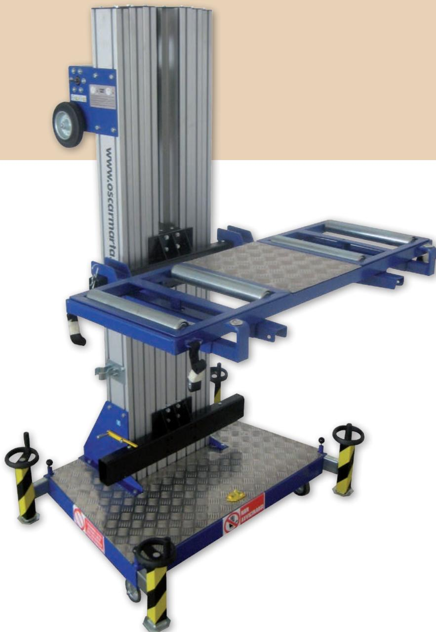
Piattaforma elevabile per cimiteri destinata all'innalzamento dei feretri e alla loro tumulazione in loculi sui vari piani. L'alzaferetri consente doppia tumulazione sia frontale che laterale, cambiando solo la posizione dei quadrotti porta rulli. La macchina è dotata di misure e peso ridotti per una facile movimentazione sia su scale (con apposito Kit) che su furgoni. Sempre grazie alle dimensioni estremamente ridotte è possibile utilizzarlo dentro alle cappelle di famiglia.
