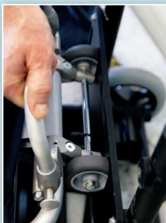
Innestare le ruote nella sede del pianale anteriore per evitarne lo scivolamento e completare il fissaggio con cinghie.
