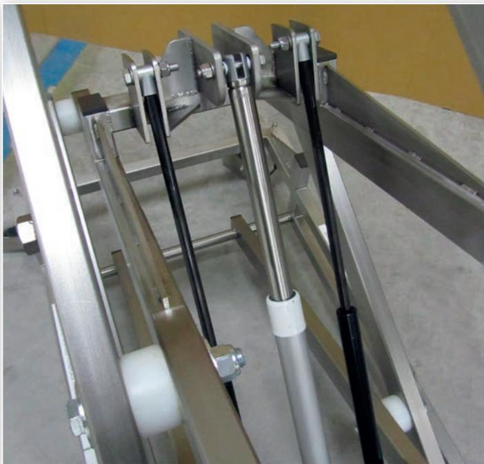
Carrello elevatore con molle a gas supplementari per capacità migliorata a 250 kg.
