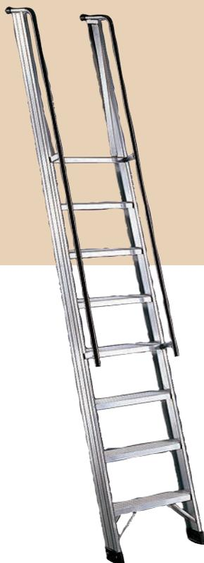
Scala costruita interamente in alluminio, montanti in profilato 103x26 mm spessore 20/10, gradini antisdrucciolo larghezza 550 mm, profondità 100 mm, mancorrenti Ø 32x15 mm.
