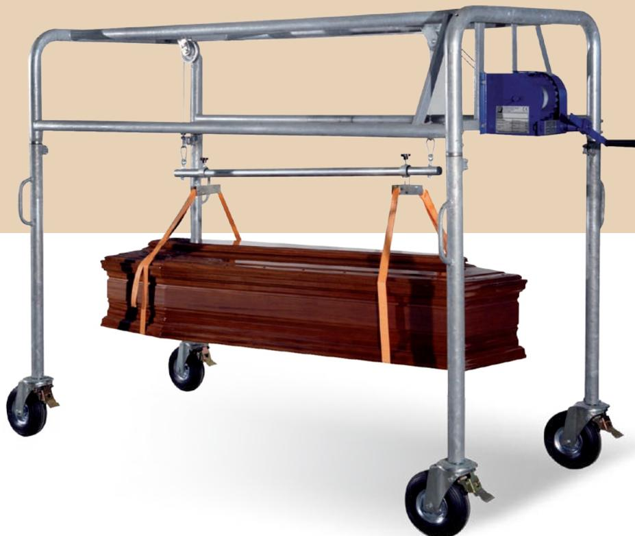
Attrezzo per la inumazione a terra dei feretri da parte di un solo operatore, di facile movimentazione grazie alle ruote piroettanti montate sulle 4 gambe, dispone di un argano manuale o elettrico che permette un abbassamento in orizzontale della cassa. Dispositivo di sbloccaggio automatico del feretro una volta calato nella fossa.
