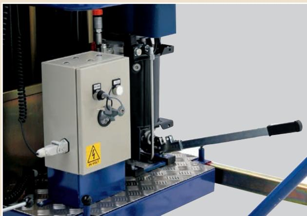
Particolare centralina per innalzamento elettrico / Detail for electric elevation
