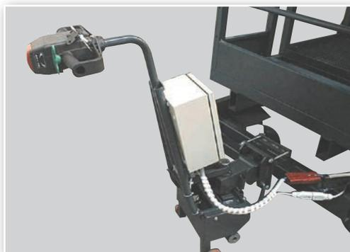
Timone di guida per traino su piano di Montafereetri con sistema di rotazione da montare su macchine elettriche non dotate di accessorio motorruota. Il kit di montaggio prevede un semplice e rapido sistema di aggancio meccanico ed innesti a spina per prelevare l'alimentazione direttamente dalla macchina Montafereetri. Progettata e costruita in conformità alla Direttiva Macchine 2006/42/CE e alla Direttiva Compatibilità elettromagnetica 2004/108/CE.
