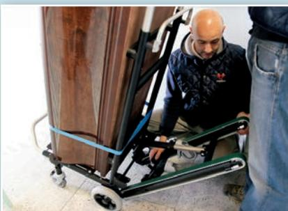
In prossimità del primo gradino, richiamo del carrello ruote posteriori e apertura carrello cingoli.
