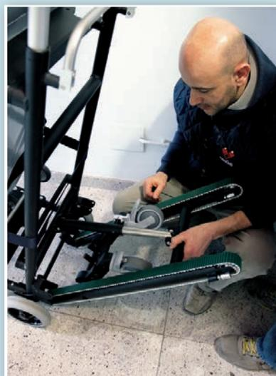
In prossimità del primo gradino, richiamo del carrello ruote posteriore e apertura carrello cingoli.
