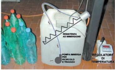
Fig. 8 Apparato per la termostatazione dell'acqua
