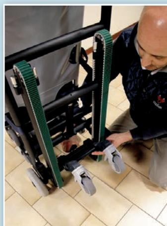
Messa in posizione verticale, apertura carrello posteriore con ruote.
