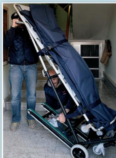
Al raggiungimento del piano di arrivo, richiamo carrello cingoli e riapertura carrello ruote posteriore per riassumere la configurazione di movimentazione in piano.
