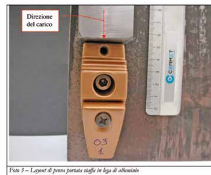
Foto 2 - Layout di prova portata aletta staffa in lega di alluminio
