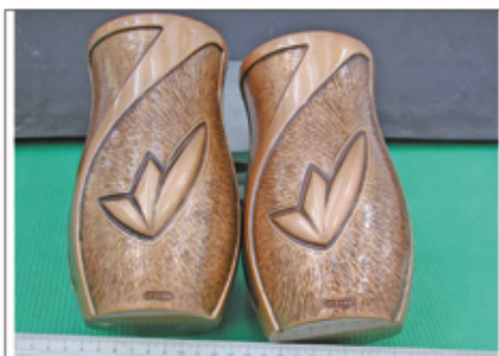
Foto 2 - Campione A e B al termine della prova in camera a nebbia salina neutra (t = 1008 h)
